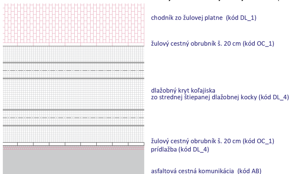
Obrázok 142_Pôdorysná schéma koľajiska – dlažobný kryt na Americkom námestí (táto schéma nenahrádza kladačský plán)
