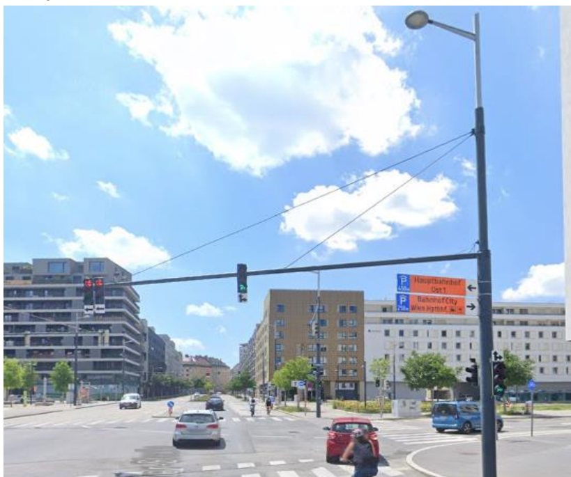
Obrázok 155_Príklad integrácie CDS so stožiarom verejného osvetlenia, Viedeň
